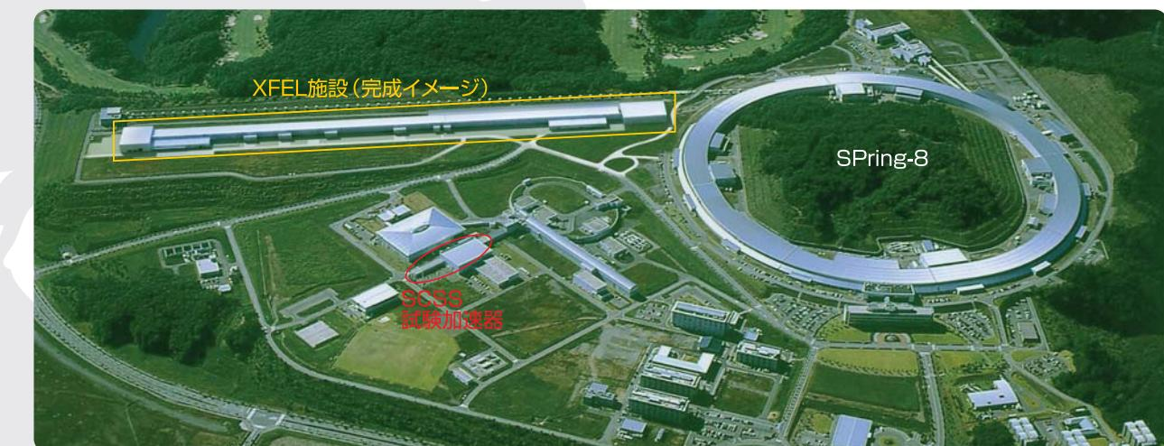
XFEL施設(黄色のラインで囲んだ部分)はSPring-8蓄積リングの隣に建設しています。赤色で囲んだ部分はSCSS試験加速器と呼ばれるXFELのプロトタイプ機です。
